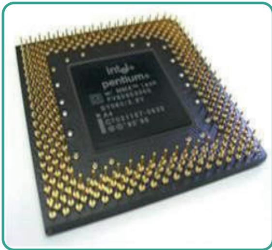
Processador Plástico (A): Base Plástico preto com pinos dourados com núcleo preto sem a chapa alumínio;
