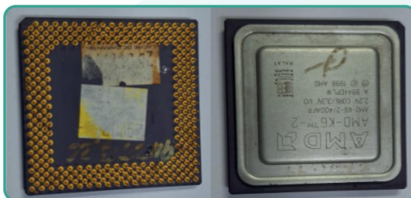
Processador Cerâmico (C): Base Cerâmico com Pinos dourados e núcleo lisos com a chapa de alumínio;
