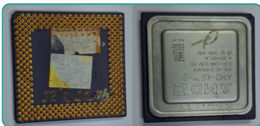
Processador Cerâmico (C): Base Cerâmico com Pinos dourados e núcleo lisos com a chapa de alumínio; Valor: R$ 250,00/kg
