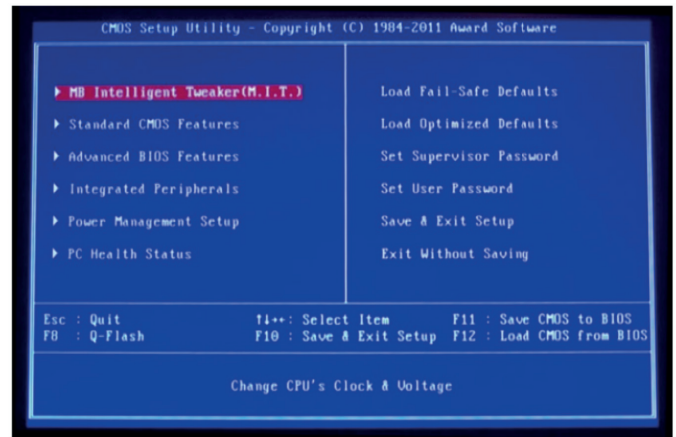
Figura 5: Tela de BIOS, navegue para baixo até “Advanced BIOS Features”
